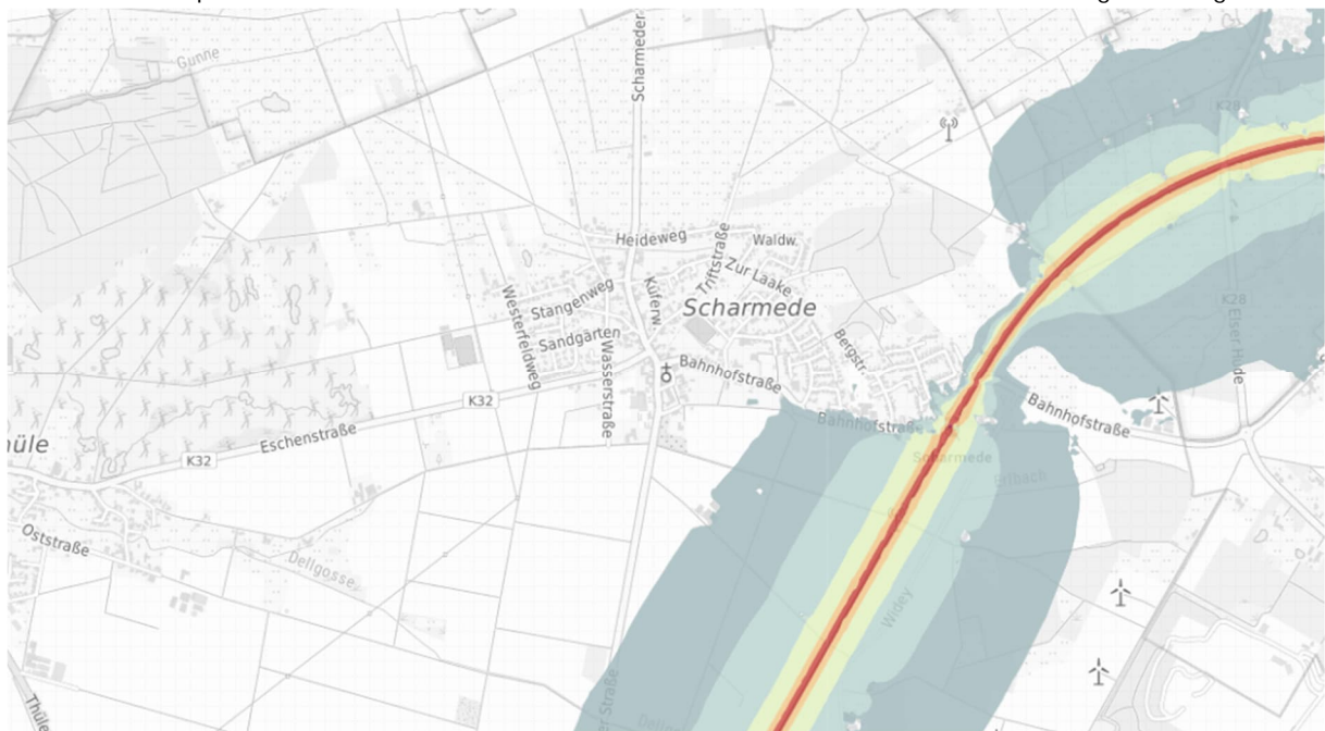
Karte 5: Isophonenkarte Schiene Nacht L NIGHT Salzkotten-Scharmede, ohne Maßstab – Auszug aus Anlage V
